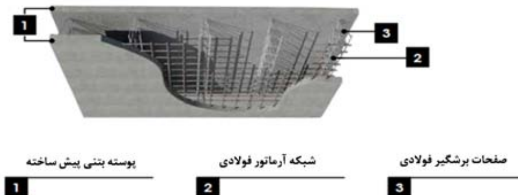
شکل 1-1 اجزای اصلی دیوار پیش ساخته سه بعدی (ساندویچ پانل) [2]
