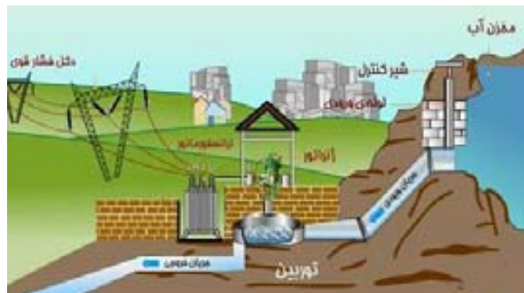
شکل ۱۲: تولید انرژی برق از نیروی آب (بر اساس اختلاف ارتفاع)
