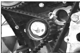
علامت تایمینگ روی سیستم سوپاپ تسمه‌ای (پونتیاک Tempest)
