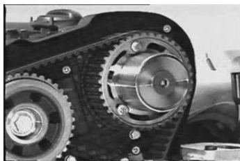
علامت تایمینگ روی سیستم سوپاپ تسمه‌ای (پونتیاک Tempest)
