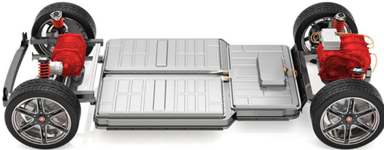
شکل ۱.۴ نمایش یک شاسی EV با پیکر بندی دو موتور
